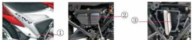
①Tapa lateral ②Tapa de filtro de aire ③Elemento
