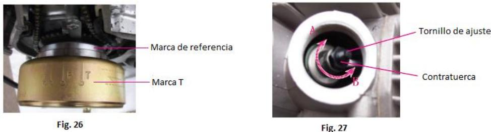
Revise o ajuste el huelgo de válvulas cuando el motor esté frío en los intervalos especificados.
