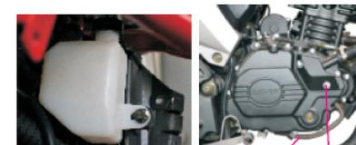
Coloque la motocicleta sobre un suelo nivelado y sosténgala con el caballete central. Una vez que el motor esté frío, ubique un envase vacío debajo de la salida del tubo de rebose del motor y desenrosque el tornillo de drenaje. Vacíe por completo el refrigerante y vuelva a ajustar el tornillo para llenar nuevamente con refrigerante.
